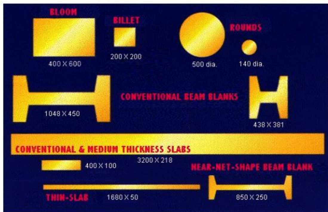
चित्र 4 - सतत कास्ट आकार (आकार मिलीमीटर में)
