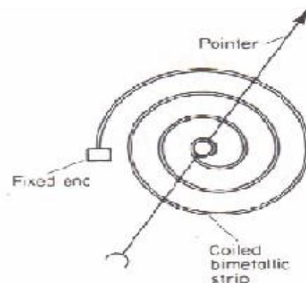
Fig. 15.8. Bimetallic thermometer
